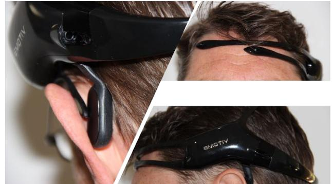
Abbildung 3: Aufsetzen des Headsets von Emotiv' zur Messung von Hirnströmen. Das linke Bild zeigt mögliche Probleme bei Brillenträgern
